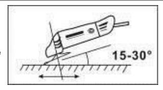
la meuleuse est maintenue selon un angle de 15-30° par rapport à l'élément à meuler. Déplacez doucement la meuleuse le long de l'élément. Laissez à la meuleuse le temps nécessaire pour son travail. Il est rarement nécessaire d'appuyer fortement le disque contre la surface à travailler. Des étincelles peuvent apparaîre dans le compartiment moteur en cours d'utilisation. Ceci est normal et ne signifie pas que la meuleuse est défectueuse. Mettez la meuleuse hors tension après utilisation.
